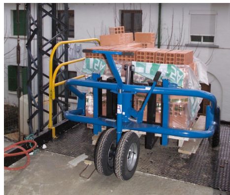
Transporte de tijolos em pisos irregulares
