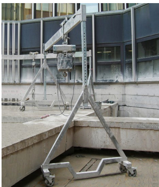
Pórtico Móvel montado em desnível
